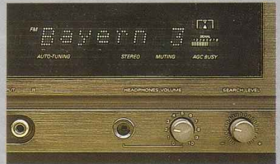
Wohlgeformte Buchstaben und Ziffern dank Dot-Matrix: Der T-9000 kann die RDS-Informationen im Klartext anzeigen
