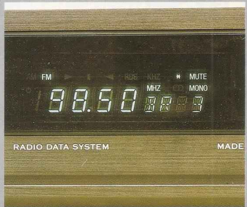
Radio-Daten auf Schmalspur-Display: Der Programmname wird vierstellig angezeigt – bei Bedarf im Durchlaufbetrieb
