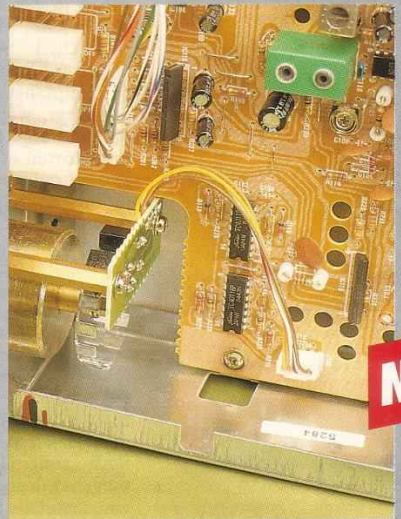
Schwingvolles Handrad: Die Segmentscheibe taucht in die Infrarotstrecke des Optokopplers – so werden die Abstimmimpulse erzeugt
